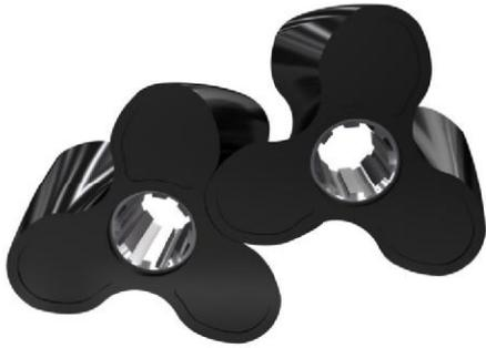
螺旋自吸式转子的泵，它具有标准的转子泵所有技术特点和功能，除此之外还具有较强的自吸能力达-0.8bar(吸程8M)。
